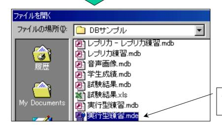
通常のデータベース(MDBファイル)を、 実行型データベース(MDEファイル)に することにより、フォームやレポートの デザインが変更できないようにする。フォー ムレポートのデザインを変更するには、 基となっている通常のデータベース (MDBファイル)に変更を加え、再度実 行型データベースに変更し、使用する。
